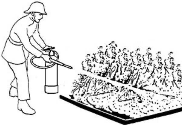
Fig. 9-9. La descarga de espuma debe ser directa para que haga una capa que caiga sobre el líquido inflamable.
