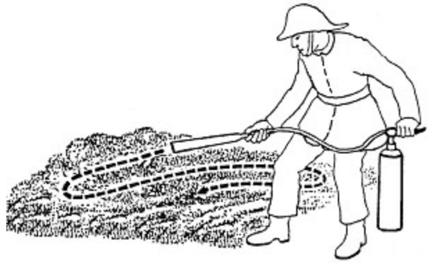
Fig. 9-10. Extintor de dióxido de carbono. Aplicar en forma de barrido sobre la superficie del material inflamable.
