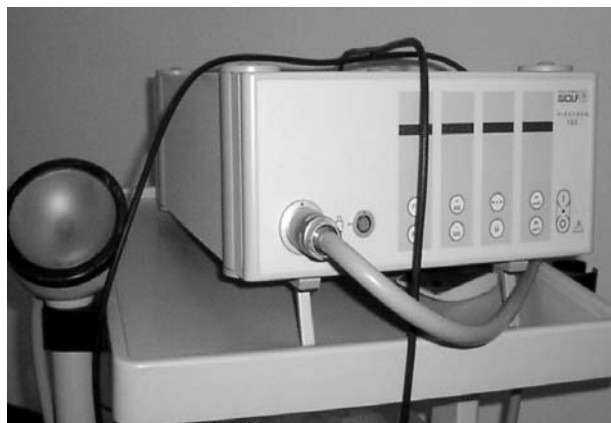
Fig. 1.—Aparato generador de ondas de choque basado en el fenómeno piezoeléctrico.
