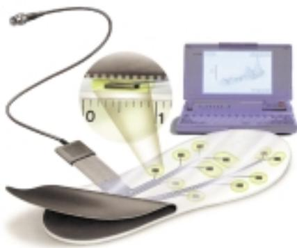
Figura 1. Plantilla dinamométrica.
