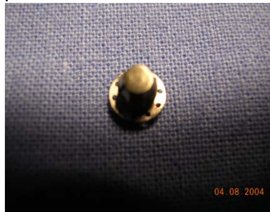
Fig.5-Vista posterior da flange.
