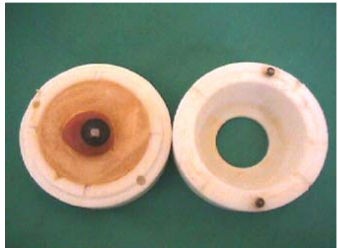
Fig. 3 Modelo en cera con perno acrílico en mufla
