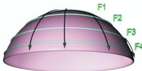
Fig. 4: Distribución de la fuerza por anillos en un conformador liso.
