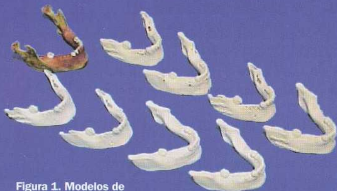
Figura 1. Modelos de prototipagem rápida em impressão tridimensional e sinterização seletiva a laser , obtidos a partir de dados de tomografia computadorizada e tomografia volumétrica.
