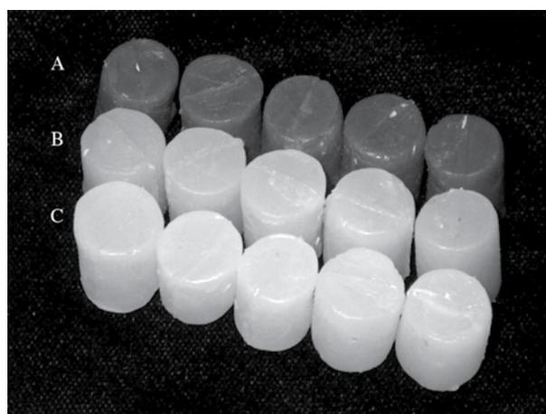
**Figura 1.** Amostras de silicone para prótese facial (A – pigmentação por óxido de ferro, B – sem pigmentação, C – pigmentação por pó de maquiagem), para os testes de rasgamento (superior) e de recuperação elástica (inferior).
