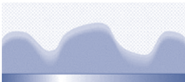
2. Falla en la penetración
